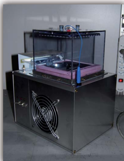
Abb.2. Fertiggestellte Diffusionsnebelkammer mit Peltier-Elementen
